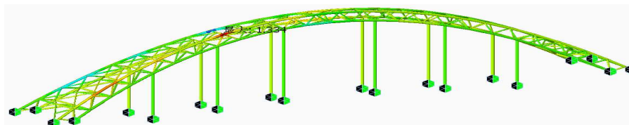
Dy 位移云图, 最大位移 1.33mm
