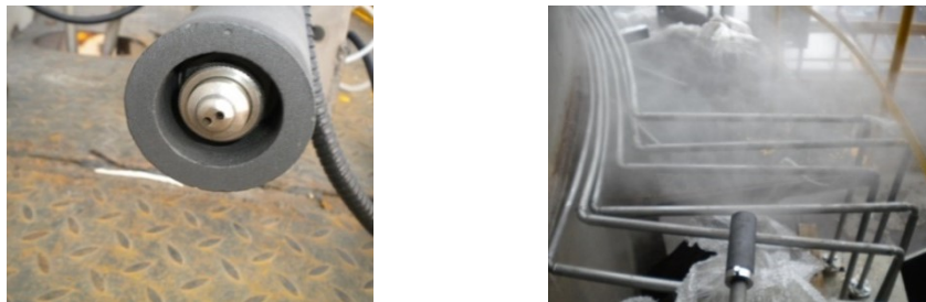
图 5 某工程双孔喷嘴及喷射效果图
